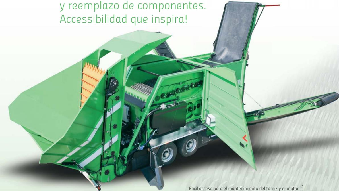
Facil acceso para el mantenimiento del tamiz y el motor
