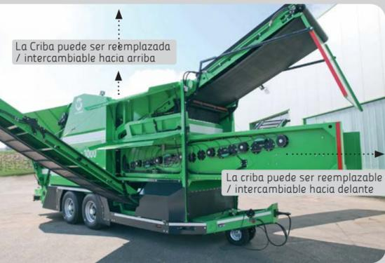
La Criba puede ser reemplazada / intercambiable hacia arriba
