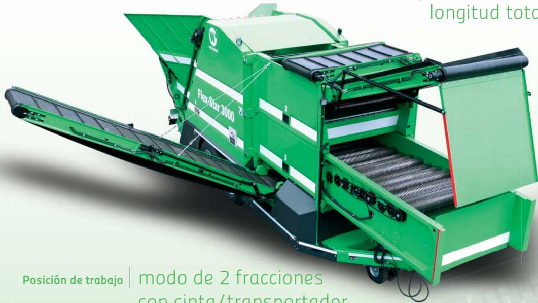
Posición de trabajo | modo de 2 fracciones con cinta/transportador de grano medio plegado
